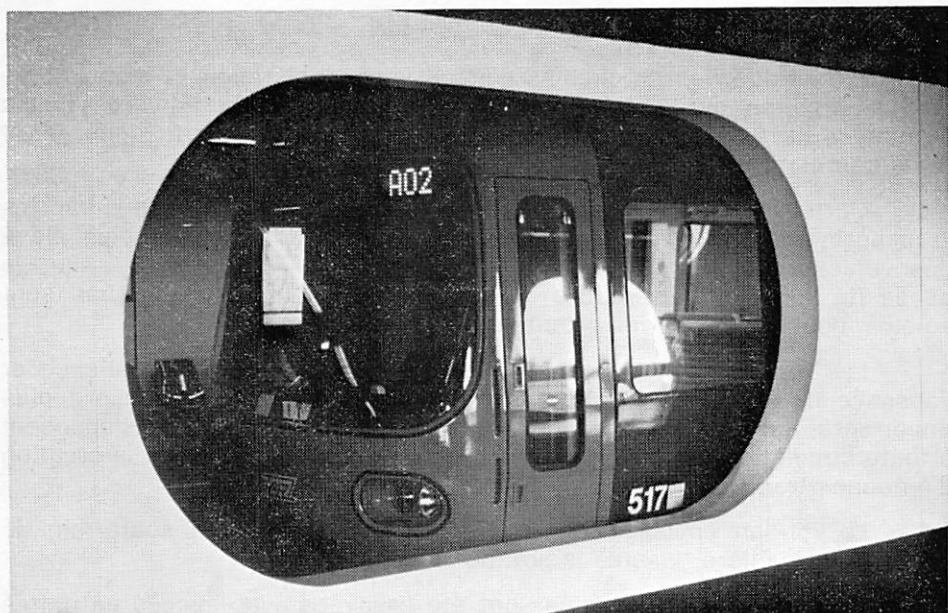
Voiture N° 517 derrière le voile en béton qui sépare les voies à l'intérieur de certaines stations (Photo Donnay de Casteau 1978) Wagen nummer 517 achter de betonnen scherm die, in enkele stations de sporen scheidt (Foto Donnay de Casteau 1978)
